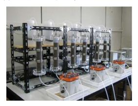
図-2 カラム通水試験装置写真 2)-4)
