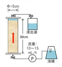
図-1 カラム通水試験装置の概要 2)-4)
