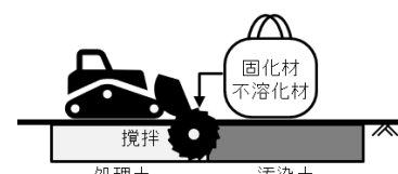
図- 1 固化・不溶化工法概要図
