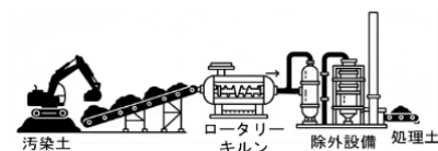
図-3 熱分解概要図
